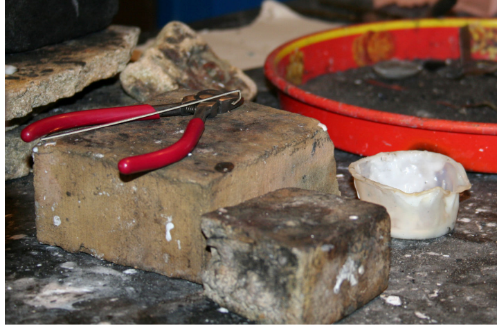
Silverlod på den röda tången och borax, till höger i bild, i den vita plastbehållaren. Tången används för att klippa bitar av silverloden.
